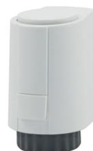
Moteur thermoélectrique 24V proportionnel (0-10V) N.C. (normalement fermé) avec bague de connexion VA64, à utiliser uniquement avec les vannes d'équilibrage automatique EvoPICV Série 93.
