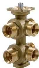
EvoSIX vanne à six voies pour les applications de HVAC à 4 tuyaux pour effectuer automatiquement le passage hiver-été ou, si nécessaire, le contrôle des plafonds radiants, des ventilo-convecteurs et des poutres froides. Résistant à la corrosion.
