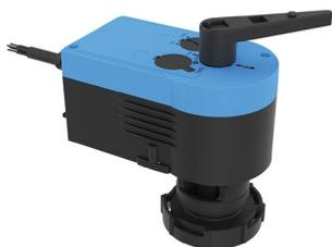
Moteur électrique 24V avec mode de contrôle proportionnel (0-10V) ou 2 / 3 points pour vannes EvoSIX six voies (63/2). Permet de gérer automatiquement la commutation été/hiver ou l'éventuel réglage des plafonds chauffants, ventilo-convecteurs et poutres froides.
