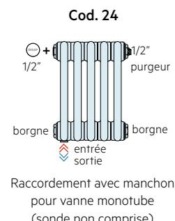
Raccordement MONOTUBE vertical avec manchon soudé Cod. 24
