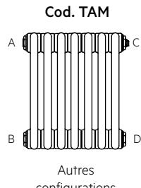
D'autres configurations sont possibles avec des diamètres de réductions différents : 1", 3/4", 1/2", 3/8", 1/4", borgne
