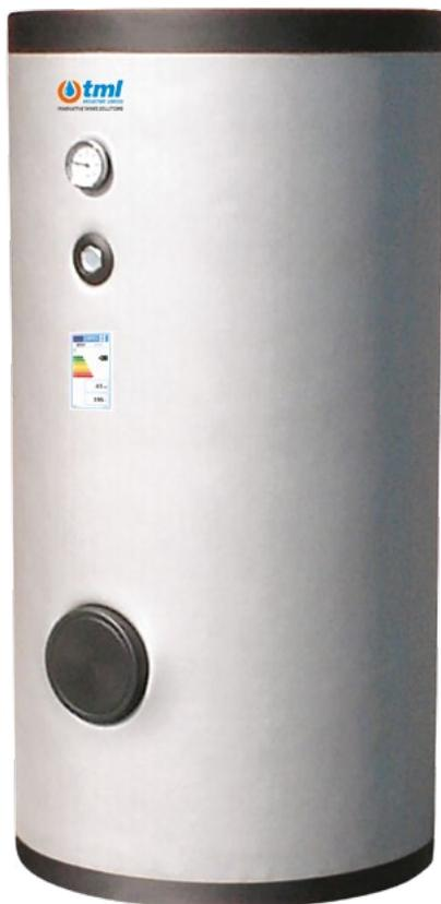
Préparateurs construits en acier au carbone émaillé pour la production et le stockage d'eau chaude sanitaire (ECS). Ils sont équipés d'un ou deux échangeurs de chaleur internes à serpentin fixe pouvant être alimentés par une pompe à chaleur et un système solaire. L'échangeur de chaleur spécial à double serpentin parallèle permet une transmission plus efficace de la puissance fournie par la pompe à chaleur dans les parties les plus froides
